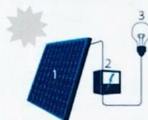
1. Zonnepaneel | 2. Omvormer 3. Elektrische toestellen
